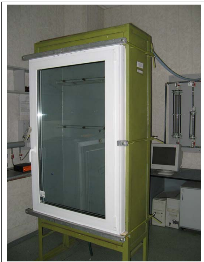
Рис. П1.1 Схема испытательного стенда для определения воздухопроницаемости оконного блока: 1 – герметичная камера с проемом; 2 – компрессор; 3 – регулятор расхода воздуха; 4 – газовый счетчик; 5 – шланг для воздуха; 6 – микроманометр; 7 – трубочина
